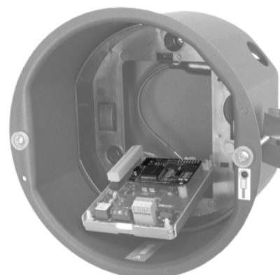
ПЛАТА ТРАНСЛЯТОРОВ TXB-V (ПОКАЗАНА ПОСЛЕ УСТАНОВКИ НА МОНТАЖНОЙ КОРОБКЕ СПЕКТРА)
