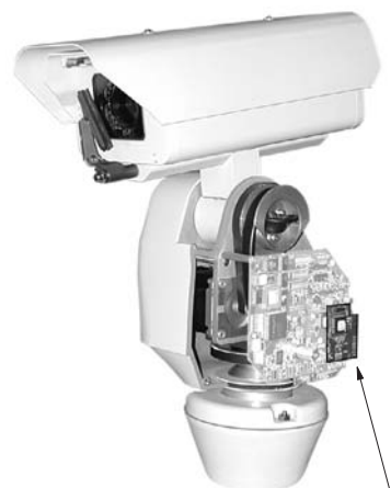
ПЛАТА ТРАНСЛЯТОРА TXB-AD (ПОКАЗАНА УСТАНОВКА ВО ВСТРОЕННОЙ СИСТЕМЕ ПОЗИЦИОНИРОВАНИЯ ESPRIT СЕРИИ ES31C) (БОКОВАЯ КРЫШКА СНЯТА)
