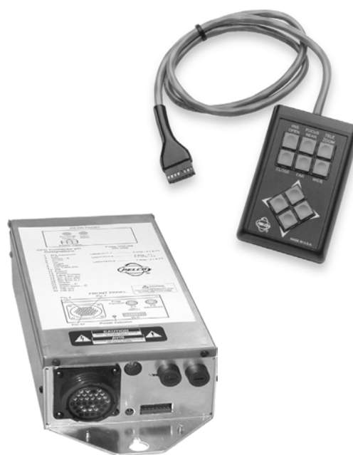
ПРИЕМНИК LEGACY LRD41A11 ПОКАЗАН С МОДУЛЕМ ТЕСТИРОВАНИЯ ЛОКАЛЬНОГО УПРАВЛЕНИЯ LRD41TLC
