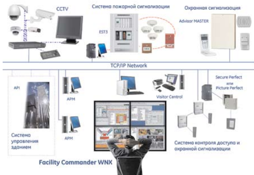
Пример структурной схемы системы безопасности на базе платформы Facility Commander WnX
